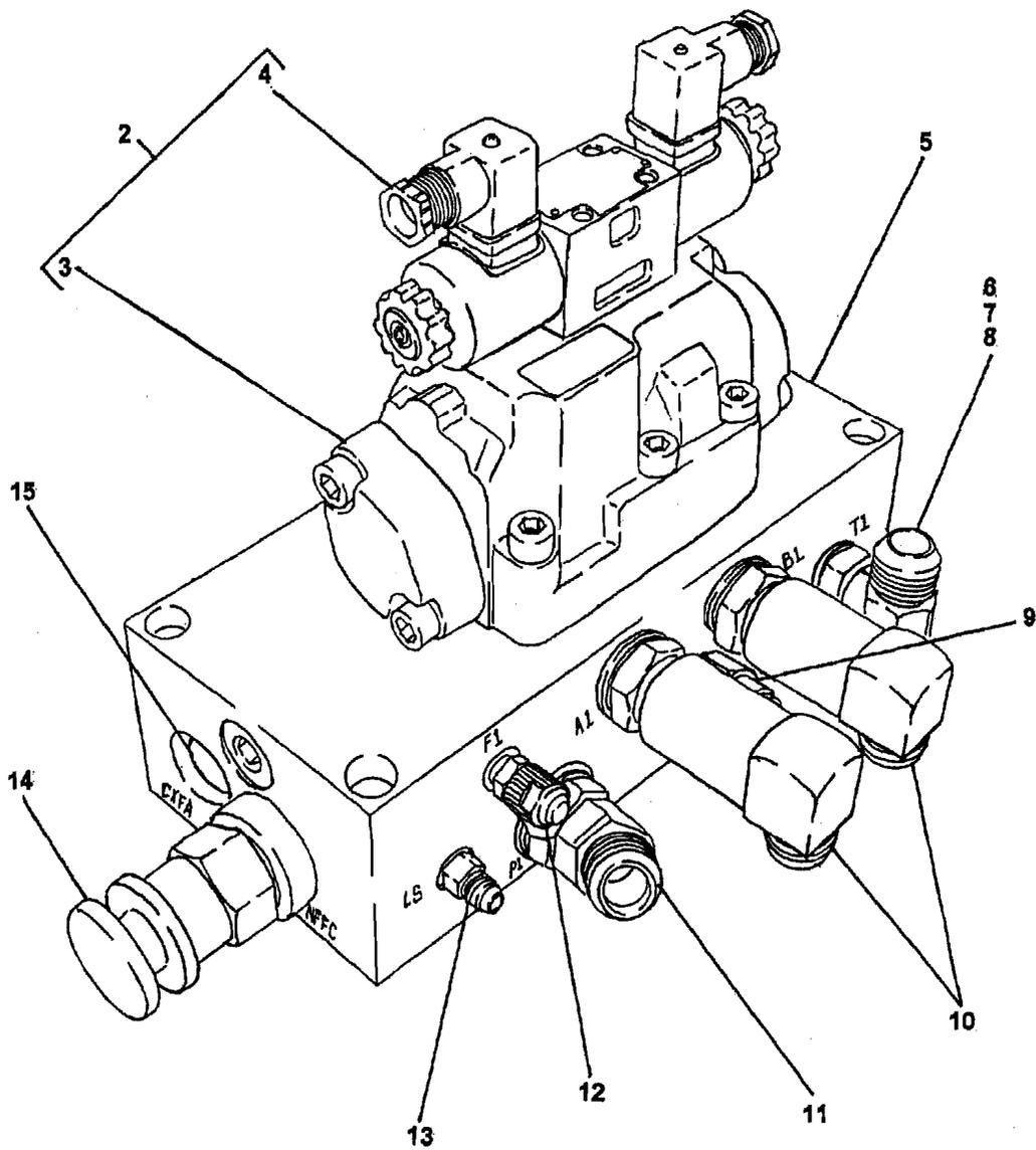
DRIVE CYLINDER CIRCUIT MANIFOLD ASSEMBLY
