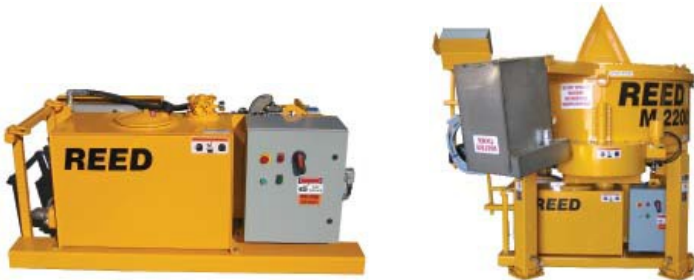
Opcional Power Pack de 50HP Puede Caber Debajo Mezcladora para Transporte
